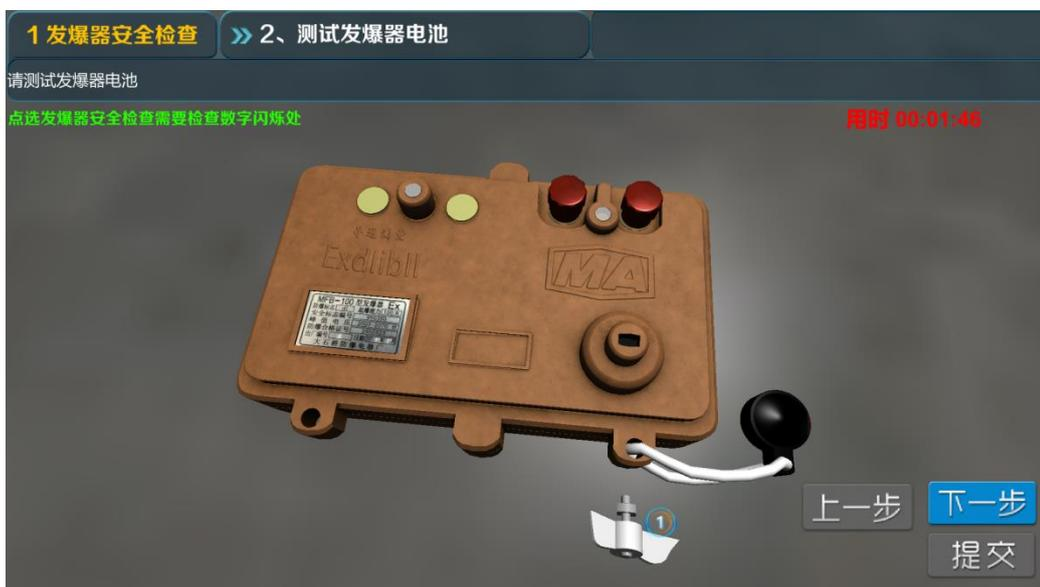
操作发爆器钥匙插入发爆器,将发爆器扭到充电位置至少5秒,充电完成后钥匙扭到放电位置,完成测试后点击【下一步】进入“电雷管安全检查”操作(如右图所示)。
